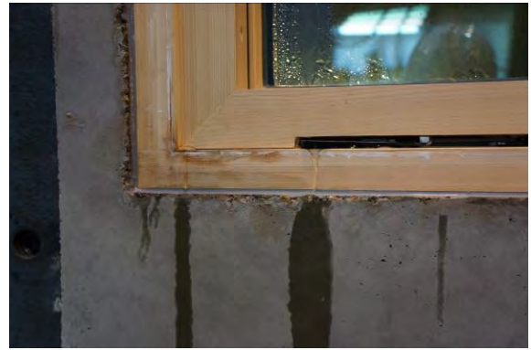
写真 6.5.3.2-37 試験体 1 流れ出し現象
