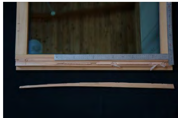
写真6.5.3.2-54 試験体3 破壊した障子材（右側）
