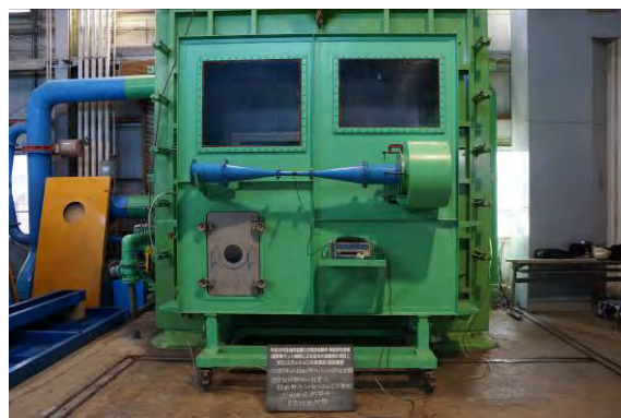
写真 6.5.3.2-31 試験体 1 (流量測定装置設置)
