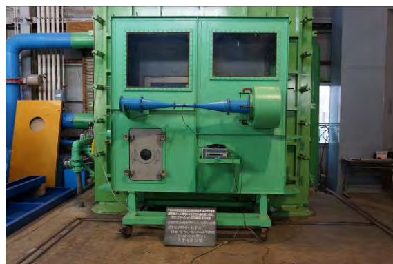
写真 6.5.3.2-33 試験体 1 (流量測定装置設置)
