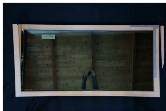
写真6.5.3.2-48 試験体2 破壊した障子
