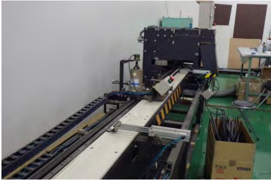
写真6. 6. 2-3 スペース一切断
