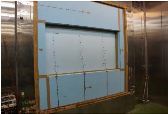
写真6.5.3.2-14 校正板計測（室内側）
