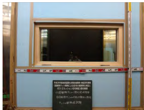
写真6.2.1-2 窓の熱還流率試験 (室内側)
