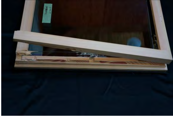
写真6.5.3.2-50 試験体2 破壊した障子（左側）
