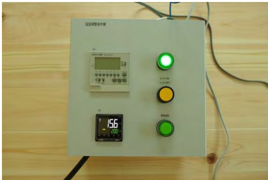
写真6. 5. 2. 1-1 温度制御装置
