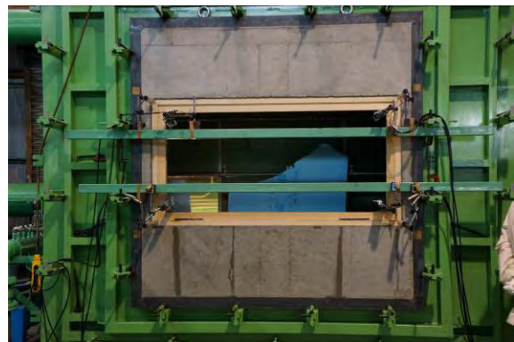
写真6.5.3.2-52 試験体3（試験後状況） 障子脱落
