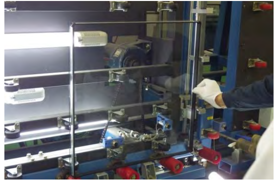
写真6. 6. 2-6 スペース貼付
