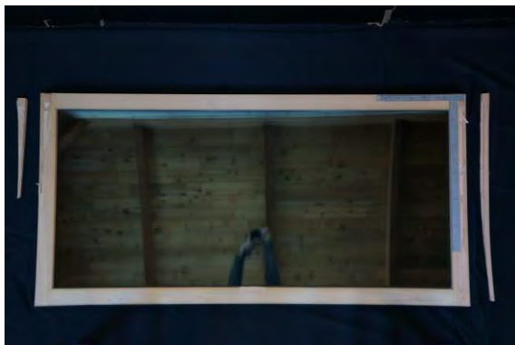
写真6.5.3.2-53 試験体3 破壊した障子材
