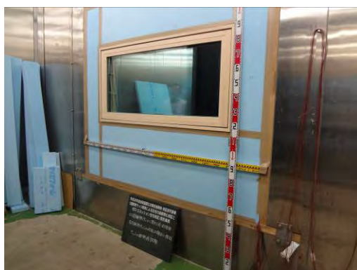
写真6.2.1-1 窓の熱還流率試験 (室外側)
