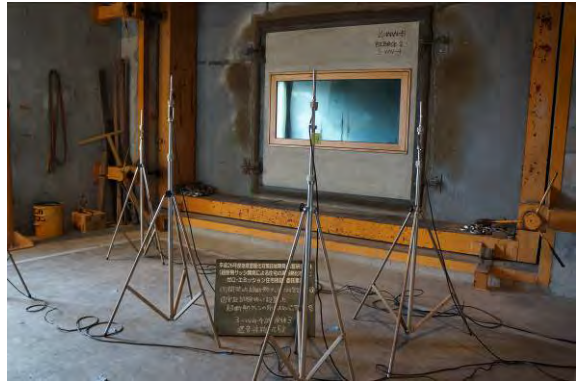
写真6.5.3.2-27 試験体3 (音源側/室外側)
