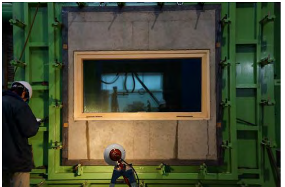
写真 6.5.3.2-41 試験体 3 流れ出し現象
