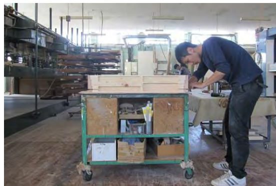
写真6. 6. 7-2 サッシ組立て
