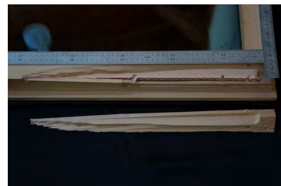
写真6.5.3.2-49 試験体2 破壊した障子 (右側)
