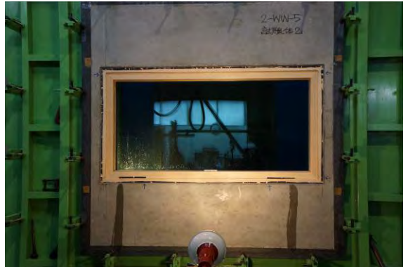
写真 6.5.3.2-39 試験体 2 流れ出し現象
