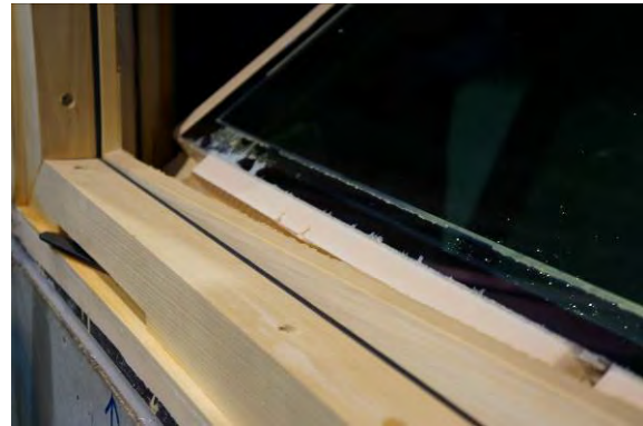
写真6.5.3.2-47 試験体2 障子材破壊
