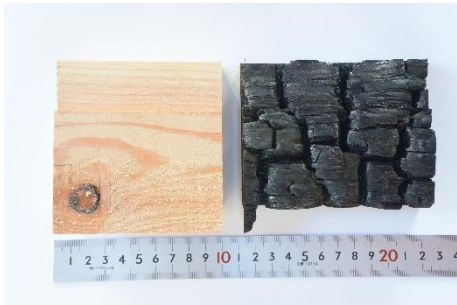
外装材 左：試験前 右：試験後
