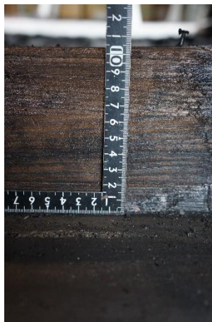
試験終了 柱燃え込み計測（高さ）
