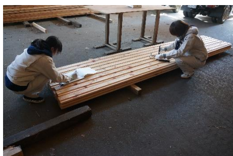
写真11 加工後材料品質確認 含水率計測
