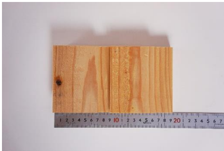
4.1.3 写真1 外装材形状 表面ラフゾーン加工
