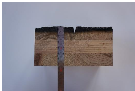
試験終了 金物 直行集成板抜き取り部断面
