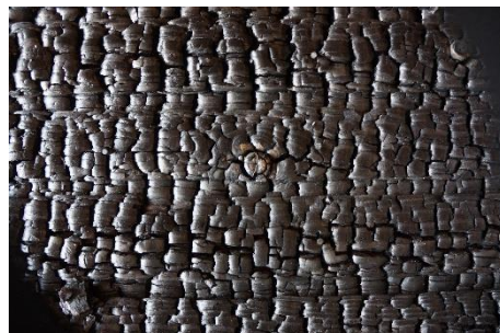
試験終了 外装材表面
