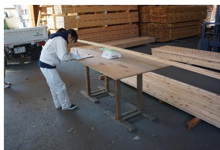
写真12 加工後材料品質確認 質量計測
