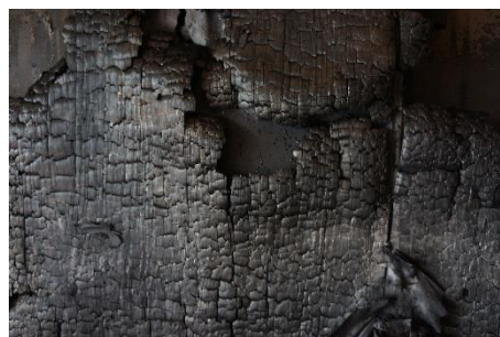
試験終了 試験体表面（試験体下部）
