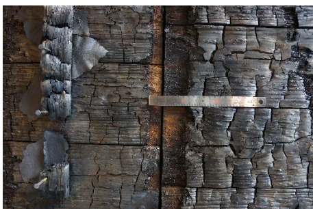
試験終了 試験体表面 直行集成板継ぎ目計測
