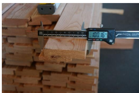
写真9 加工後材料品質確認 寸法計測
