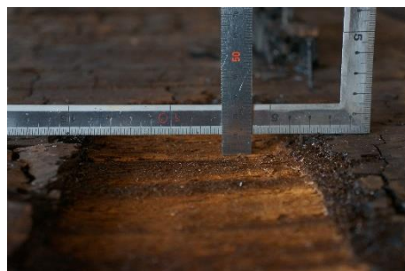
試験終了 試験体表面 直行集成板燃え込み計測
