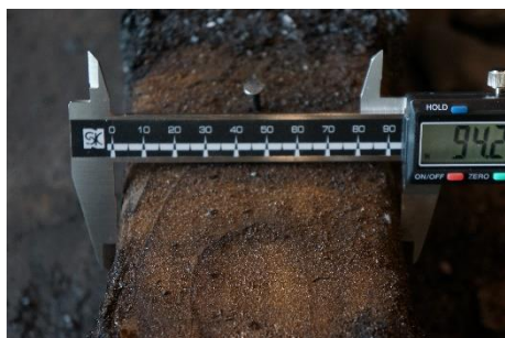
試験終了 柱燃え込み計測（幅）
